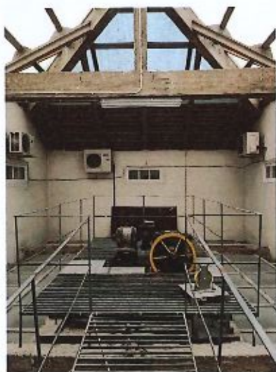
Fig. 22 – Mecanismo montado no vão do telhado para tomada de fotografias de obras de arte sobre a sala inferior.
